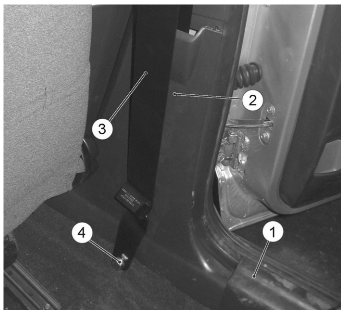
Рисунок 15 – Крепление переднего ремня безопасности:
