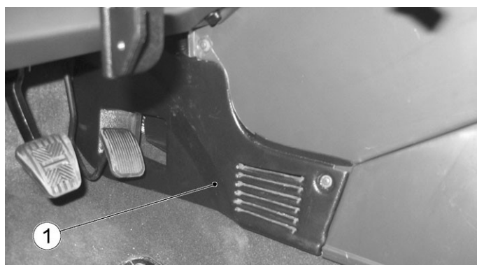
Рисунок 11 – Снятие экрана бокового левого:
